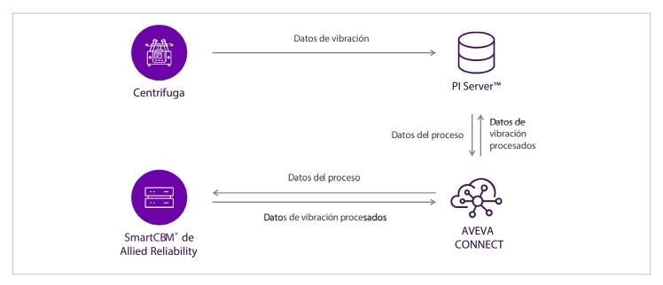
Los datos de AVEVA PI System, históricos y en tiempo real, de REG se envían a Allied utilizando AVEVA CONNECT. La solución SmartCBM de Allied realiza análisis de datos y envía recomendaciones a AVEVA PI System utilizando la API REST.
